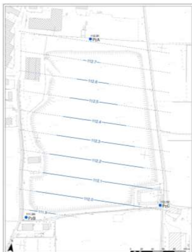
Fig. 3.6 – Piezometria 2 settembre 2013 (dati trasduttori di pressione e PzA calcolato) (fonte: valutazione dati piezometrici 2013 – ex – cava Vailata)
